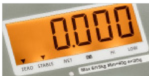
Checkvägningsfunktion med skiftande bakgrundsbelysning - (orange, grön, röd).
